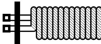
Das Rippenrohr ist aus Kupfer und verzinnt auf eine Flanschplatte mit Ø 290 mm montiert. Der Wärmetauscher hat eine galvanische Trennung.
